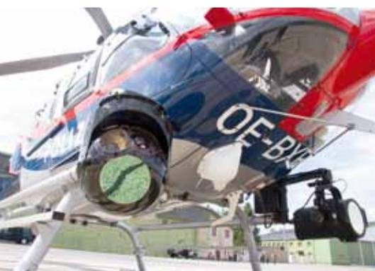
Der BMI-Hubschrauber mit der „FLIR – Forward-Looking-Infrared“-Kamera
