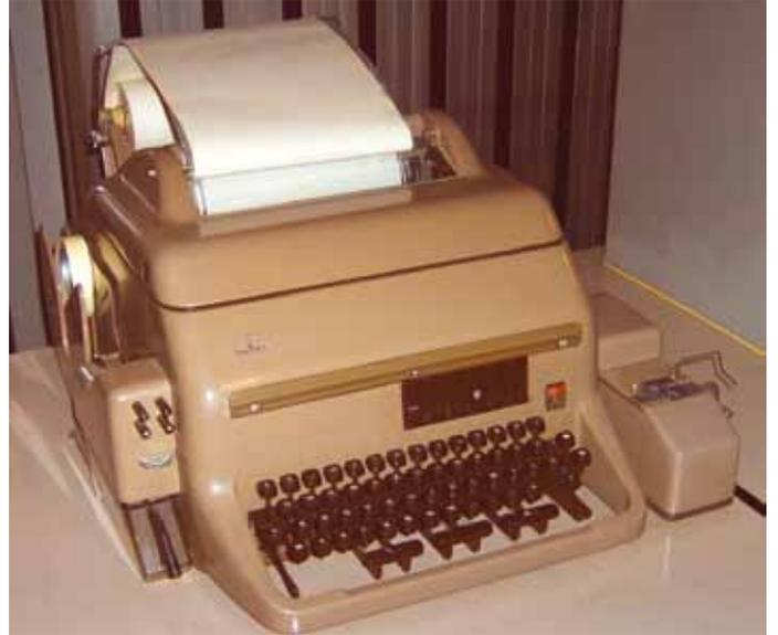
*Das Werkzeug eines Fernschreibers „Siemens T100 mit Lochstreifen-einrichtung“*
