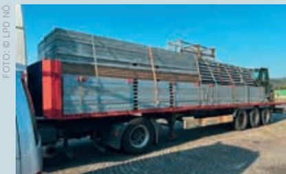
Sattelkraftfahrzeug mit sichtbar mangelhafter Ladungssicherung
