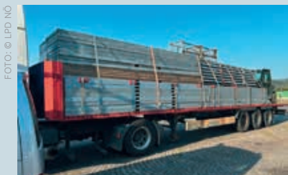
Sattelkraftfahrzeug mit sichtbar mangelhafter Ladungssicherung
