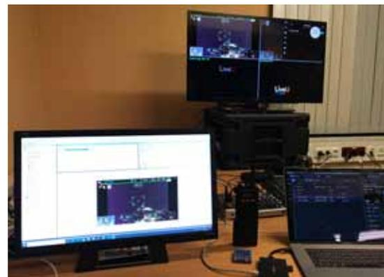
Das Testsetting am BPK Schärding: Monitor am 4-fach Splitter, darunter LU2000-Server; am linken Monitor wird das Videosignal an einen Milestone-Server weitergegeben und aufgezeichnet; am Notebook sieht man die LiveU-Geräte-Management-Console.
